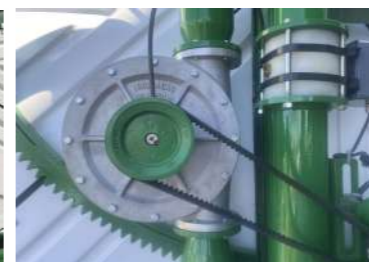
Turbina Hidráulica em Alumínio / Moto Redutor
